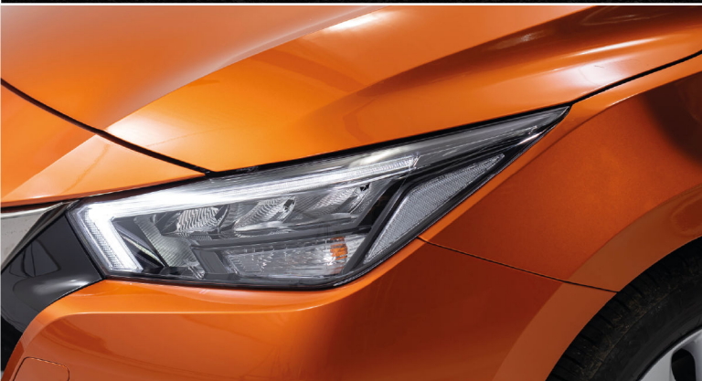
Cụm đèn pha LED dạng boomerang tích hợp dải LED chạy ban ngày.
